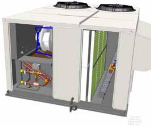
La HWC se aplica allí donde se requiere calor adicional. El agua caliente procede de una caldera externa u otro dispositivo. La HWC proporciona calefacción con una batería situada tras la batería interior y ofrece un control de la calefacción de modulación completa mediante una válvula de 3 vías. El control se basa en la temperatura del aire de mezcla y la temperatura de las zonas.
