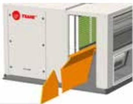
Paso 2: Coloque la brida lateral con la esquina hacia el exterior.
